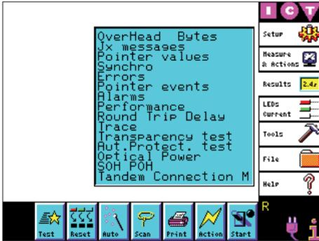
**Touch Screen zur Geräteeinstellung,** der die Funktionen des Generators/Analysators in Form eines Blockschaltbilds darstellt. Das Gerät führt den Anwender schnell und präzise auch durch komplizierte Messungen.
